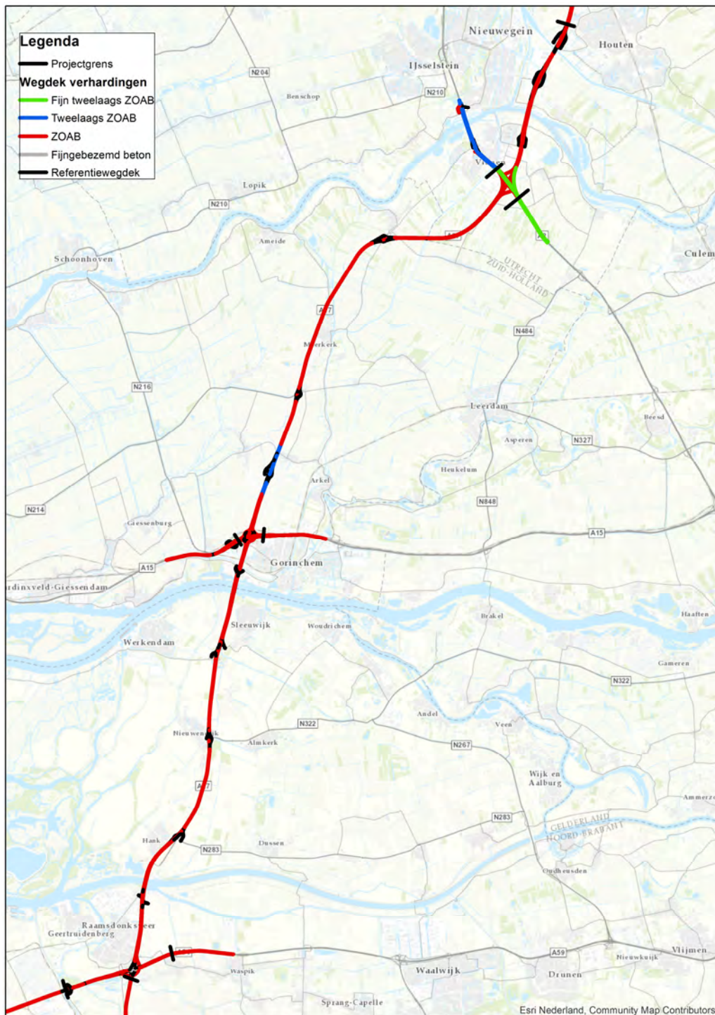
Figuur 8 Globaal overzicht van de wegdekverhardingen in het ontwerp van het project
