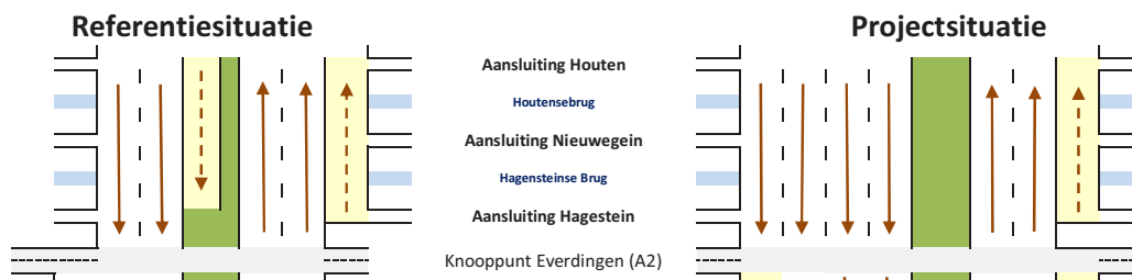
Figuur 3.2: Schematische weergave autonome en nieuwe rijstrookconfiguratie wegvak Houten - Everdingen
